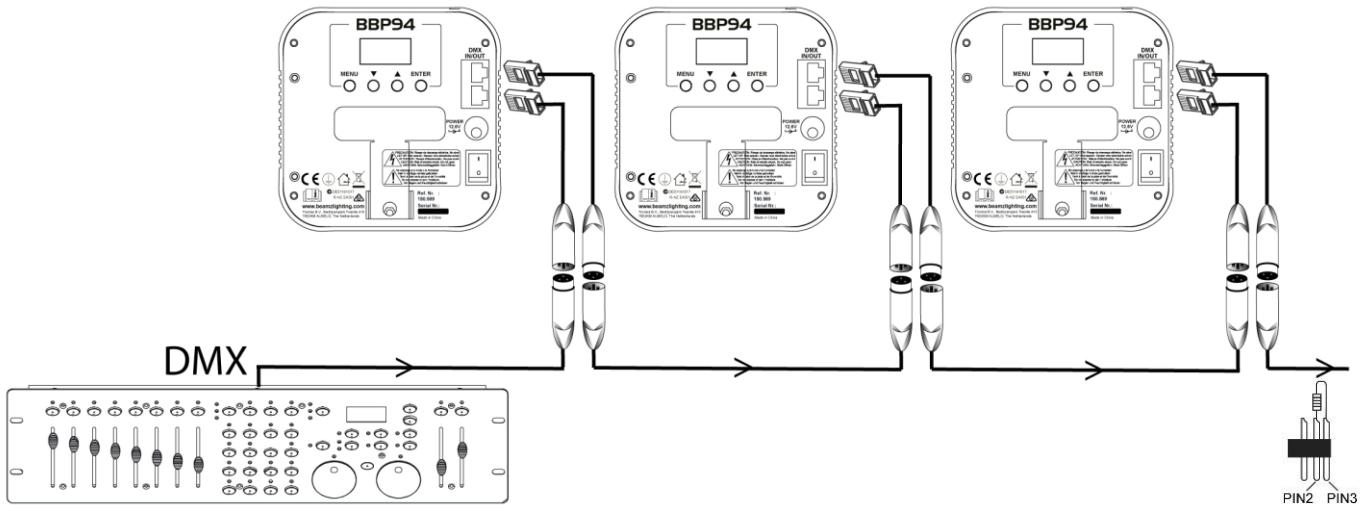
Na końcu ostatniego urządzenia należy wpiąć terminator DMX. Jest to niewielkie urządzenie wyglądające jak wtyk XLR, w którym piny 2 oraz 3 są połączone ze sobą oraz opornikiem 120 Ohm.
